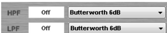
Jeder Eingangskanal verfügt über einen Tief- und einen Hochpassfilter, die wie folgt konfiguriert werden können: But(terworth) 6dB,
