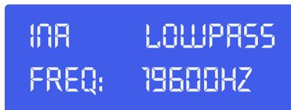
Stellen Sie ihn mit dem **Jogwheel (8)** ein. Sie können den Tiefpassfilter deaktivieren, indem Sie das **Jogwheel (8)** im Uhrzeigersinn drehen, bis die Frequenz 20kHz erreicht. Drücken Sie auf das **Jogwheel (8)**, um einen anderen Filter auszuwählen.
