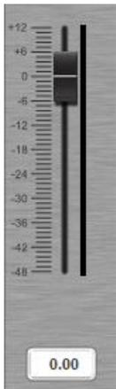
Der Verstärkerregler zeigt die Verstärkungseinstellungen an. Das Textfeld unter dem Schieberegler gibt den genauen Verstärkungswert wieder. Mit dem Verstärkungsregler können Sie die Gesamtverstärkung für jeden Ausgangskanal einstellen. Sie können die Verstärkung anpassen, indem Sie einen Wert in die Anzeige schreiben oder indem Sie den Regler mit der Maus verschieben.
