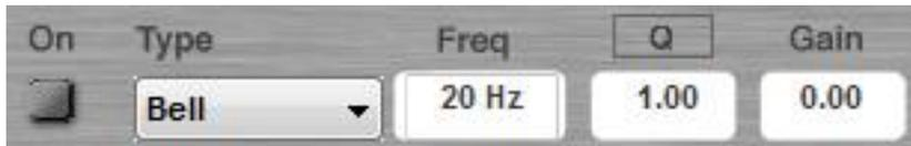
Beide Eingangskanäle verfügen über bis zu 10 parametrische Equalizer, die je als Allpass-, Bell-, High-Shelving-, Low-Shelving oder als Notch-Filter konfiguriert werden können.
