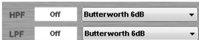
Jeder Ausgangskanal verfügt über einen Tief- und einen Hochpassfilter, die wie folgt konfiguriert werden können:
