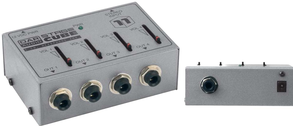
Der SC-11 ist für die Erweiterung oder Generierung von Kopfhörer-Kanälen gedacht. Das Gerät verfügt über 1/4" Stereo-Input, 4 Volume-Steuerungen, 4:1/4" Stereo-Ausgangs-Klinkenstecker und wird mit einem AC-Adapter angetrieben (dieser Adapter wird mitgeliefert). Der SC-11 hat 20Hz-20KHz Response, eine geringe Größe und ist sehr leicht zu bedienen.
