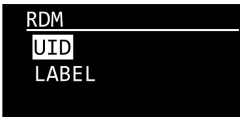
01) Drücken Sie **UP/DOWN**, um zwischen UID und LABEL zu wechseln.
